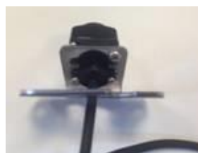
Cámara girada 180° en su soporte (quite los dos tornillos grandes, gire la cámara y vuelva a fijarla)
