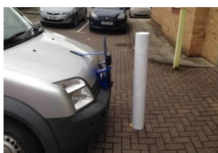
Poste de 1 m de largo enfrente de una cámara montada a 0,6 m
