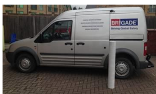
Poste de 1 m de largo bajo una cámara montada a 1,8 m
